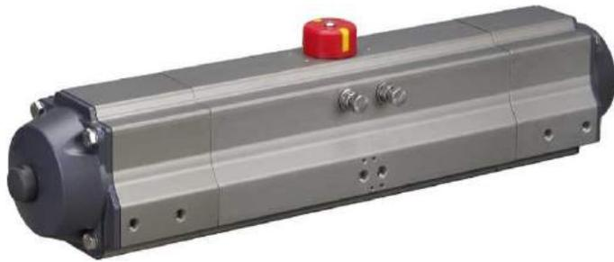
С каждой стороны пневматического привода **ARTORQ** предусмотрен пружинный узел, который предназначен для возврата в центральное положение 90° при сбросе давления или при аварии. Движение против часовой стрелки от 0° до 90° и по часовой стрелке от 90° до 180° осуществляется только подачей сжатого воздуха. В полностью открытом положении 180° и закрытом положении 0° возможна регулировка угла  $\pm 4^\circ$ .
