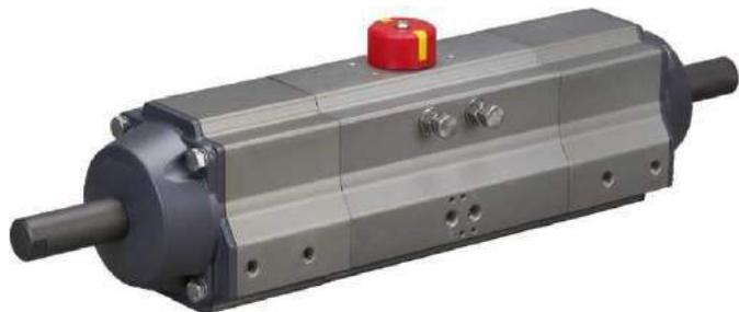
Два типа пневматических приводов с 3-мя положениями: 0°- 45°- 90° и 0°- 90°-180°. После того, как воздух поступает в цилиндр через вход воздуха "2", движение поршней к концам будет ограничено вспомогательным механизмом поршней (необходима также подача давления в порты "D"). Таким образом, поршни будут оставаться в среднем положении.
