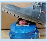
**МЕХАНИЧЕСКАЯ НАГРУЗКА.** Конструкция блока выдерживает внешнюю нагрузку в 100 кг.
