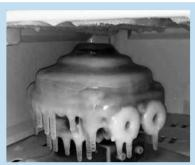
**ХОЛОД.** Работоспособность датчика проверена в экстремальных условиях при температуре минус 63°C
