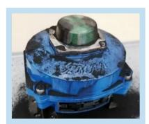
**пыль.** Температура поверхности датчика не может воспламенить взрывоопасную пылевую среду.
