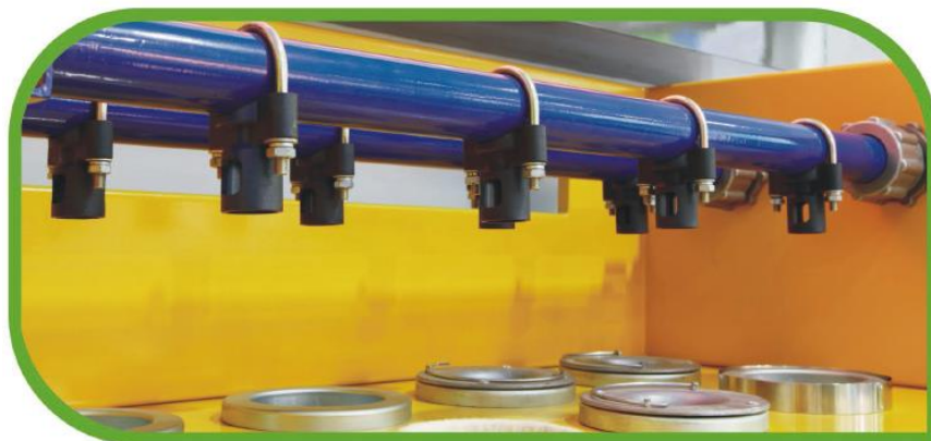
Рис.2 Способ установки сопла-эжектора SNP на продувочную трубу
